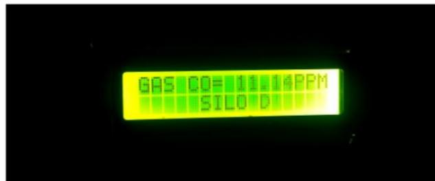
■ Gambar 13. Hasil Pengujian Ditampilkan pada LCD I2C
