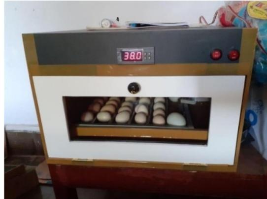
Gambar 2. Rancangan Sistem Kontrol Pada Suhu 38°C
