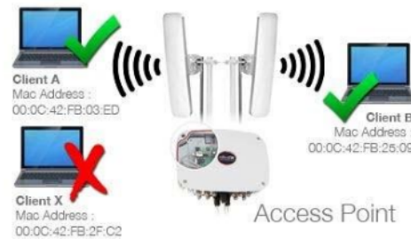
Gambar 15. contoh MikroTik dengan MAC filtering.
